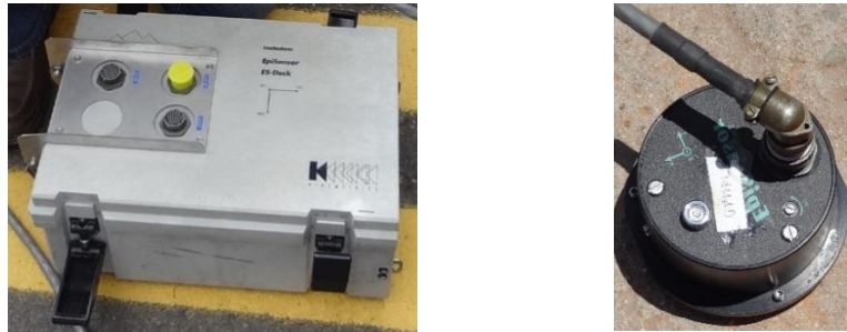
(a) (b) Figura 17. (a) Consola K2 Kinematics, (b) Episensor triaxial FBA ES-T Fuente: Autor
