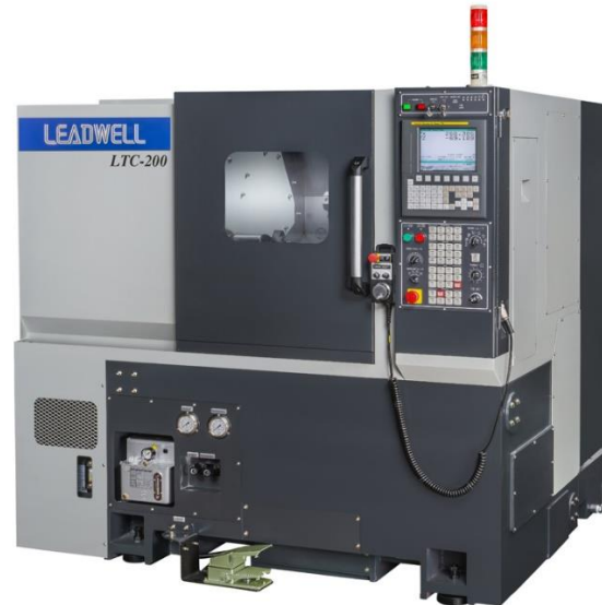
Figura 31. Torno de control numérico Leadwell LTC 200
