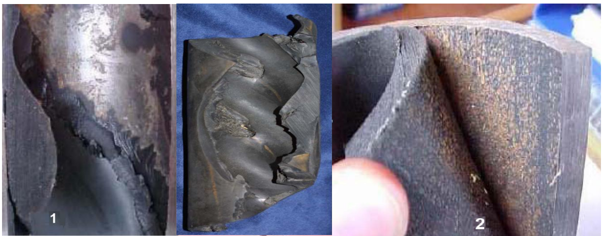
Figura 59. Elastómero dañado por goma desgarrada.
