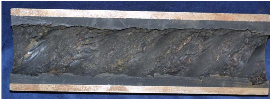
Figura 53. Elastómero dañado por altas temperaturas.
