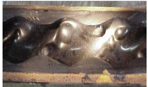
Figura 57. Descompresión explosiva en elastómeros.
