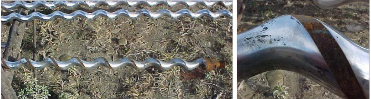
Figura 66. Efecto del rozamiento (metal-metal) sobre el rotor.
