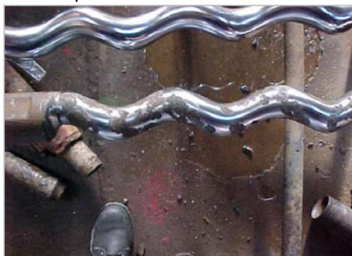
Figura 61. Ataque de fluido sobre el rotor.
