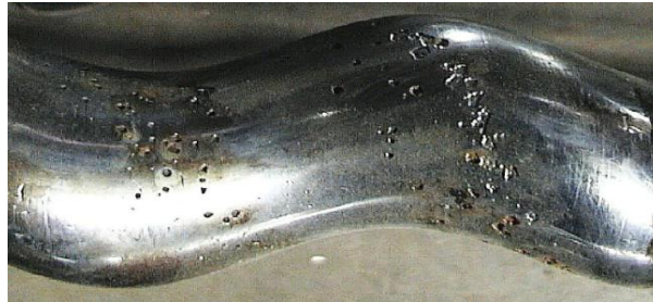
Figura 64. Rotor expuesto a una corrosión por picadura.
