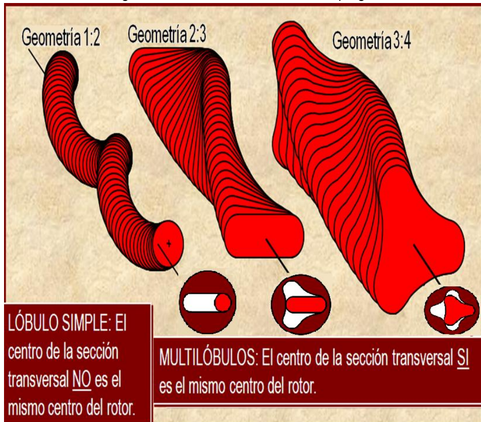
Figura 52. Generación de la geometría de bombas de cavidades progresivas tridimensional.
