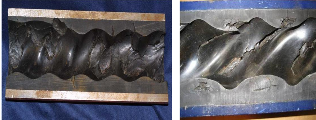
Figura 58. Delaminaciones en elastómeros debido a fluctuaciones de temperatura.
