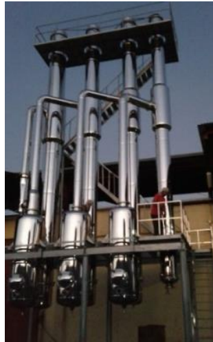
Figura 9. Evaporador de película descendente usado en la industria
