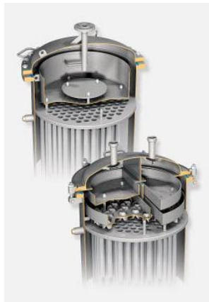
Figura 10. Evaporador en corte de sección de película descendente
