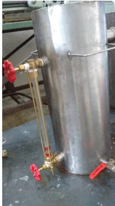
Figura 58. Tanque separador con visor y válvula
