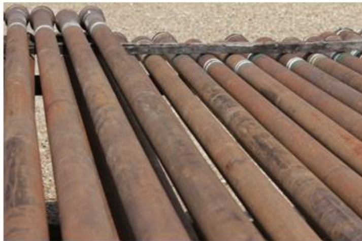
Figura 13. Tubería de producción
