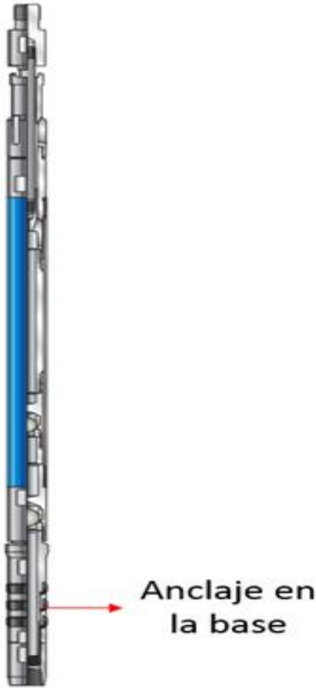
Figura 24. Bomba de insertos con anclaje en la base
