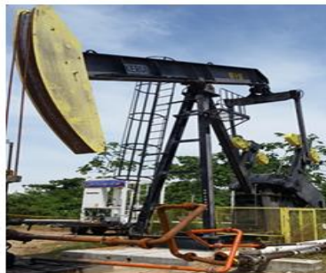
Figura 26. Unidad de bombeo convencional
