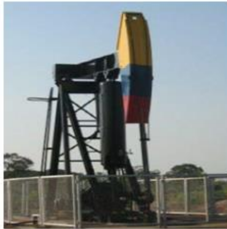
Figura 27. Unidad de bombeo balanceada por aire
