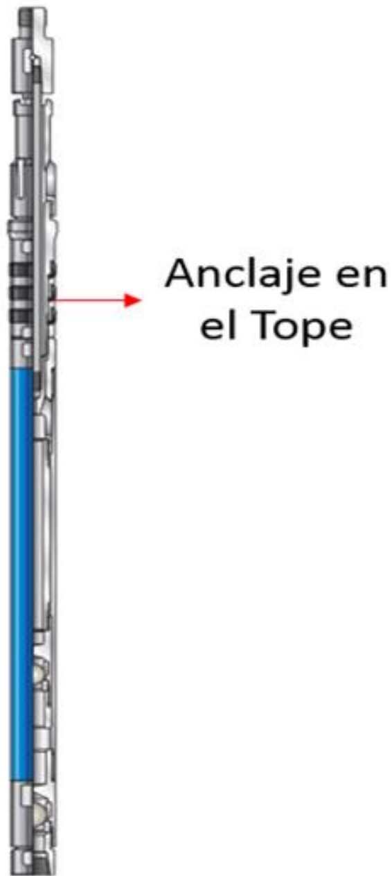
Figura 23. Bomba de insertos de anclaje en el tope
