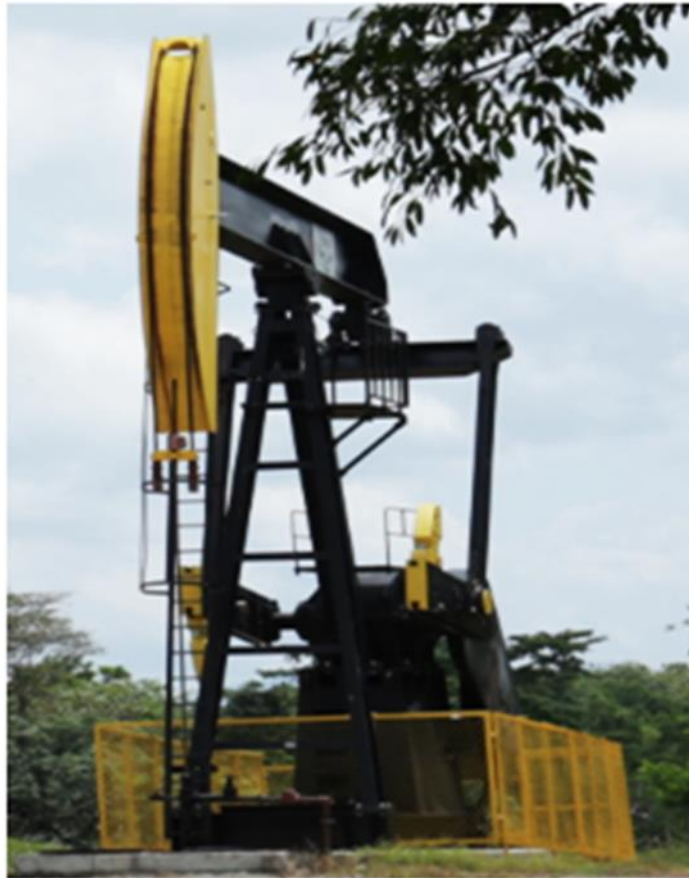
Figura 12. Unidad de bombeo mecánico convencional
