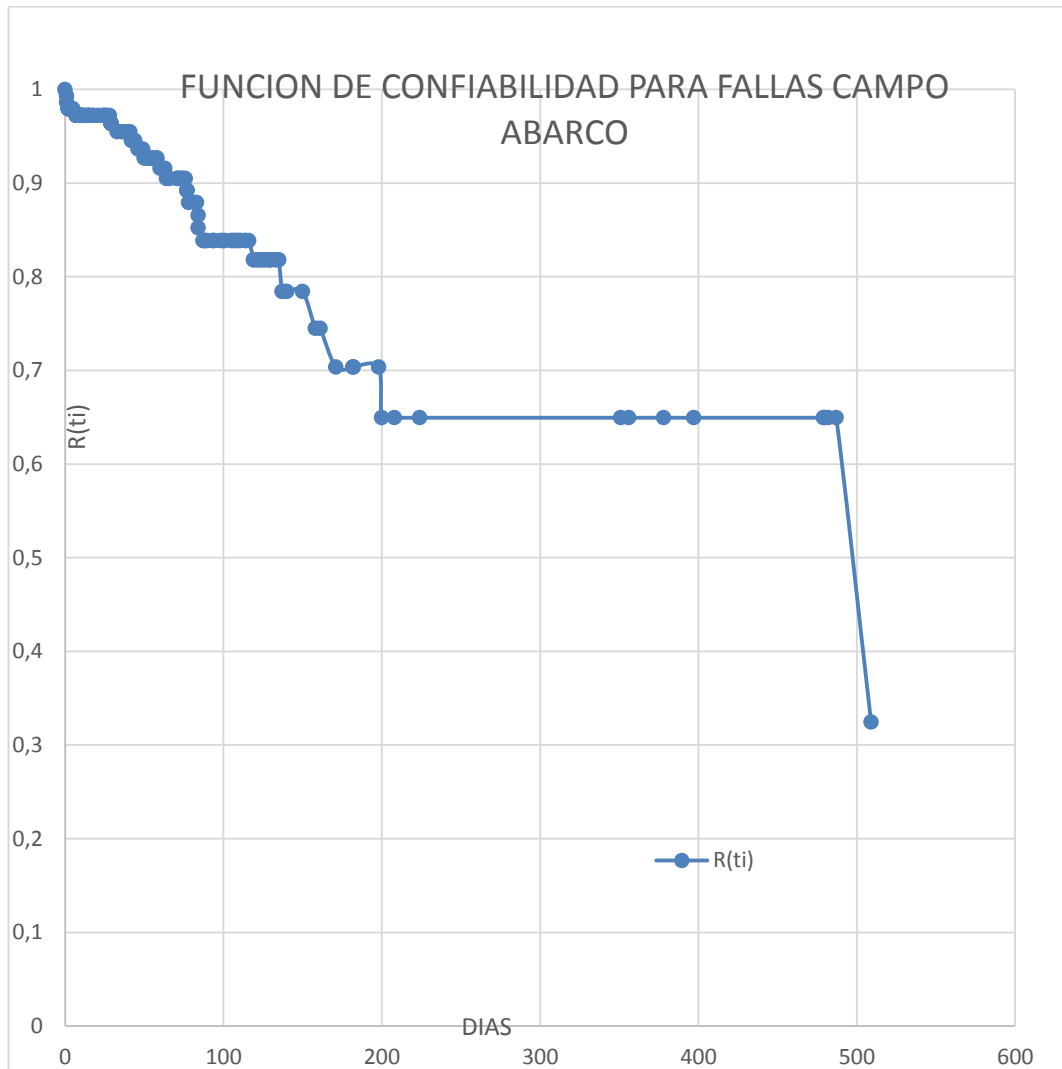
Figura 51. Grafica de función de confiabilidad para fallas Campo Abarco
