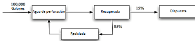
Figura 2: Uso de agua de perforación de acuerdo a la metodología 1
