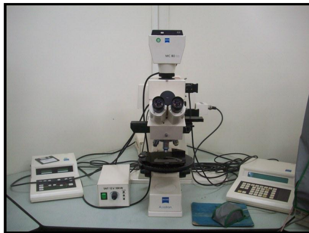
Figura 7. Fotografía del equipo que mide la Reflectancia de vitrinita: Microscopio fotómetro Zeiss Modelo MPM400.
