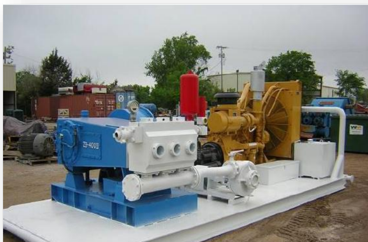
Figura 4. Bomba de lodos de tres pistones (triplex)
