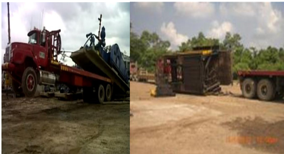
Figura 26. Malas Prácticas de Cargue y Descargue en Sistemas Convencionales
