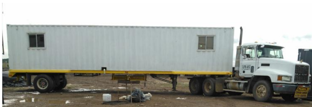
Figura 18. Caseta tipo fast-move enganchada al cabezote y lista para ser movilizada.
