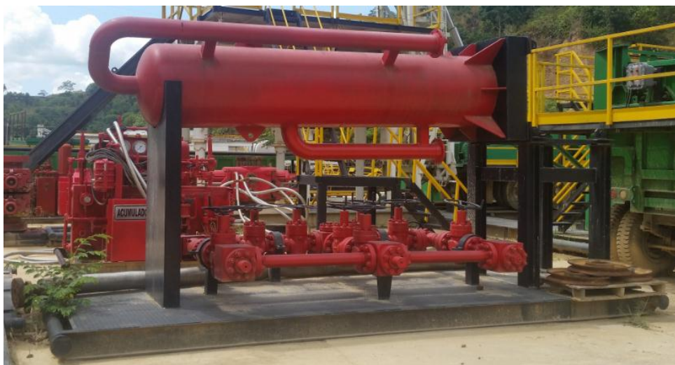
Figura 19. Choke Manifold y Poor Boy acoplados.
