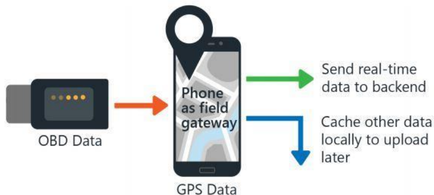
Figura 27 Integración de dispositivos de hardware y software local necesaria para integrar una solución de IoT en la nube.
