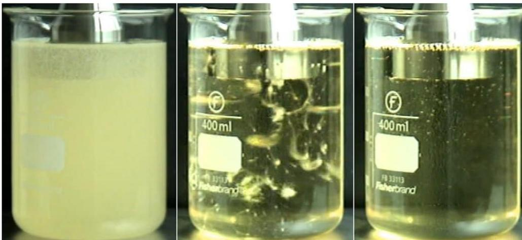
Figura 22. De-gasificación ultrasónica de condensados (5 seg). Adaptado de: [Bit.ly/2JzH9Y4](https://bit.ly/2JzH9Y4)
