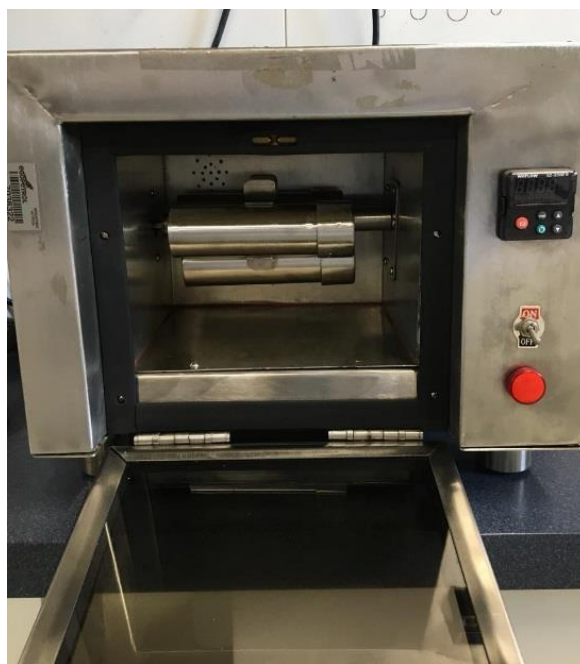
Figura 10. Horno de rodillos Prueba de acreción
