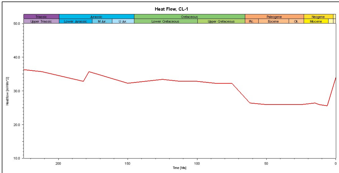
Figura 40. Ejemplo de la curva de flujo de calor a lo largo del tiempo geológico para el pseudopozo CL-1.
