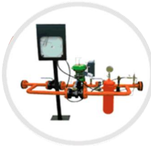
Figura 14. Skid para generar las ondas de presión
