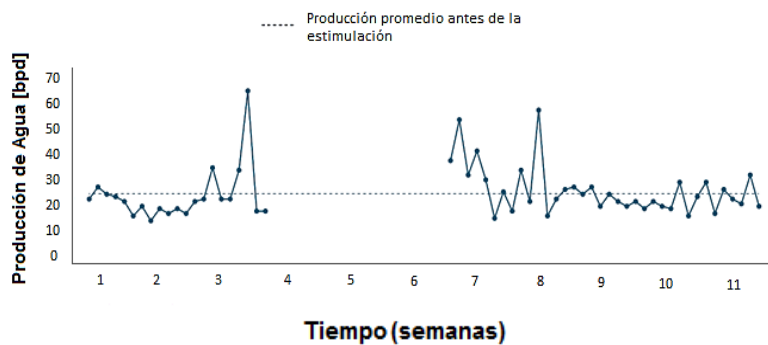
Gráfico 2. Producción de agua antes y después de la estimulación ultrasónica
