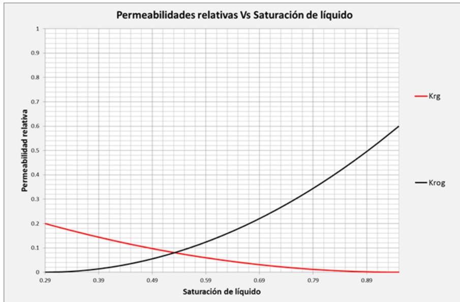
Figura 43. Curva permeabilidad relativa Vs Saturación de líquido, caso base
