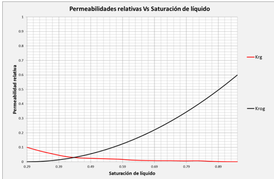
Figura 44. Curva permeabilidad relativa Vs Saturación de líquido, caso modificado
