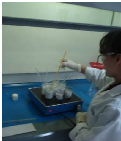
Figura 24. Extracción de los metales del filtro
