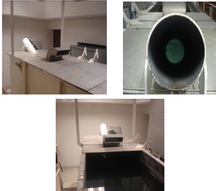
Figura 1. Tanque recuperador de proyectiles
