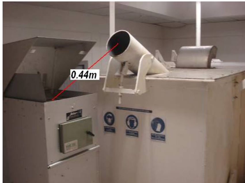
Figura 16. Muestreador HI-VOL a 0.44 m respecto a la boca de fuego del arma
