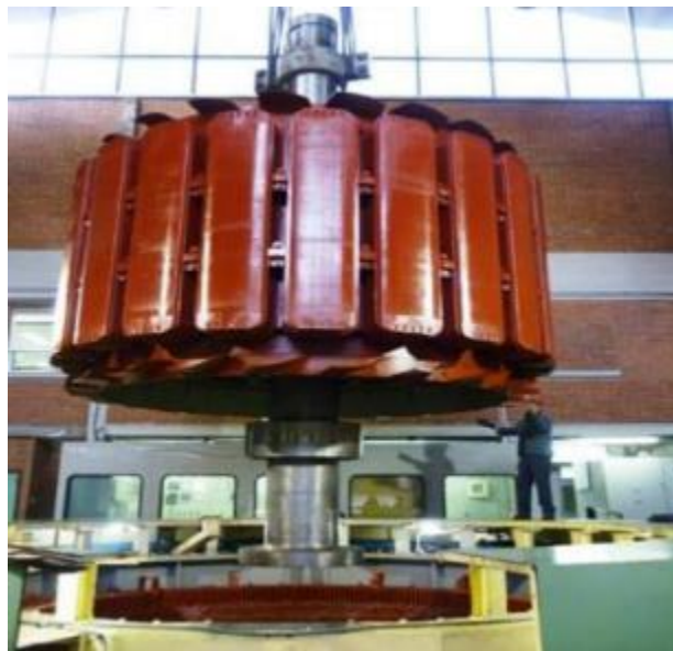
Figura 8. Generador eléctrico: Rotor central de generación Charquito.
