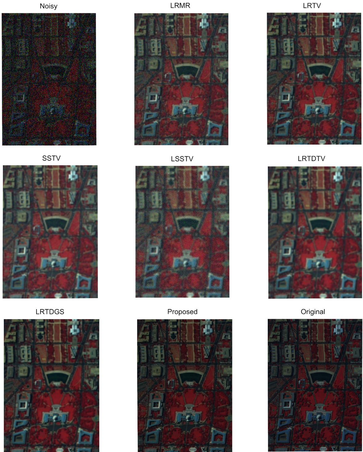
Figura 9. Comparación visual de los métodos LRMR, LRTV, SSTV, LSSTV, LRTDTV, LRTDGS y la propuesta para la eliminación de ruido usando el conjunto de datos Washington DC MALL.
