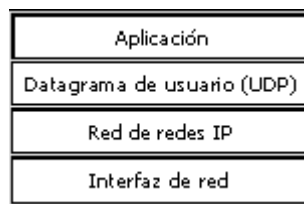
Figura 8. Lugar de UDP en las capas de TCP/IP
