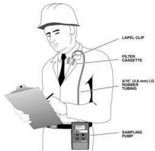
Figura 10. Modo de uso de la bomba de muestreo en el trabajador.
