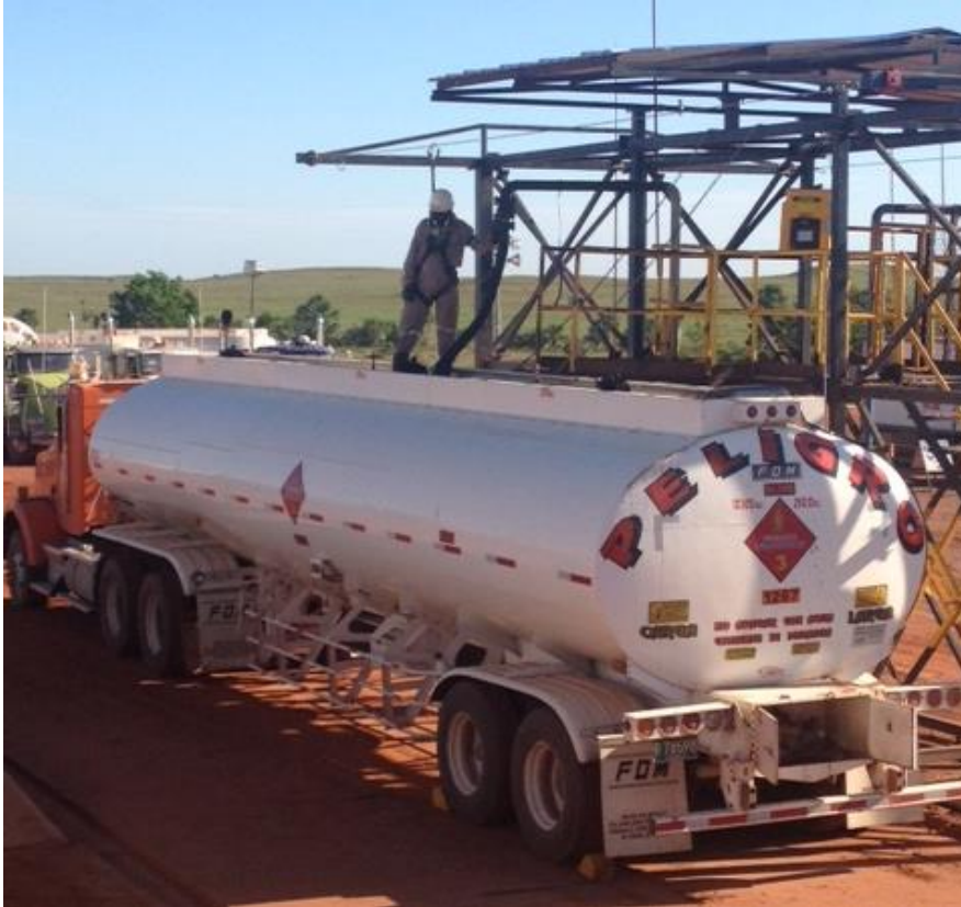
Figura 14. Sistema de cargue de crudo
