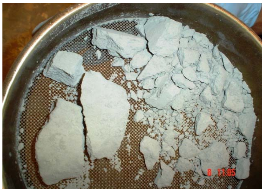
Foto 3. Estado del cemento aterronado en el momento de destapar el saco.
