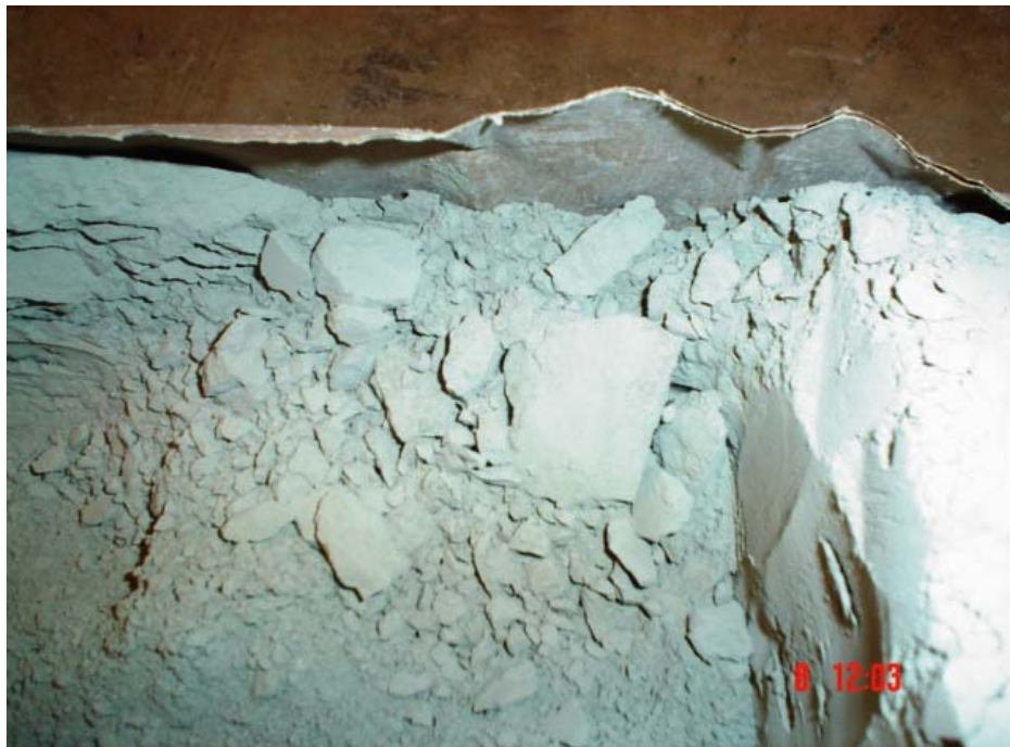
Foto 4. Cemento aterronado en las esquinas de los sacos
