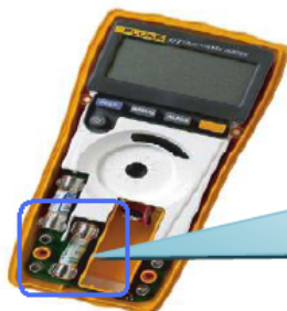
Figura 11. Fusible de un multímetro
