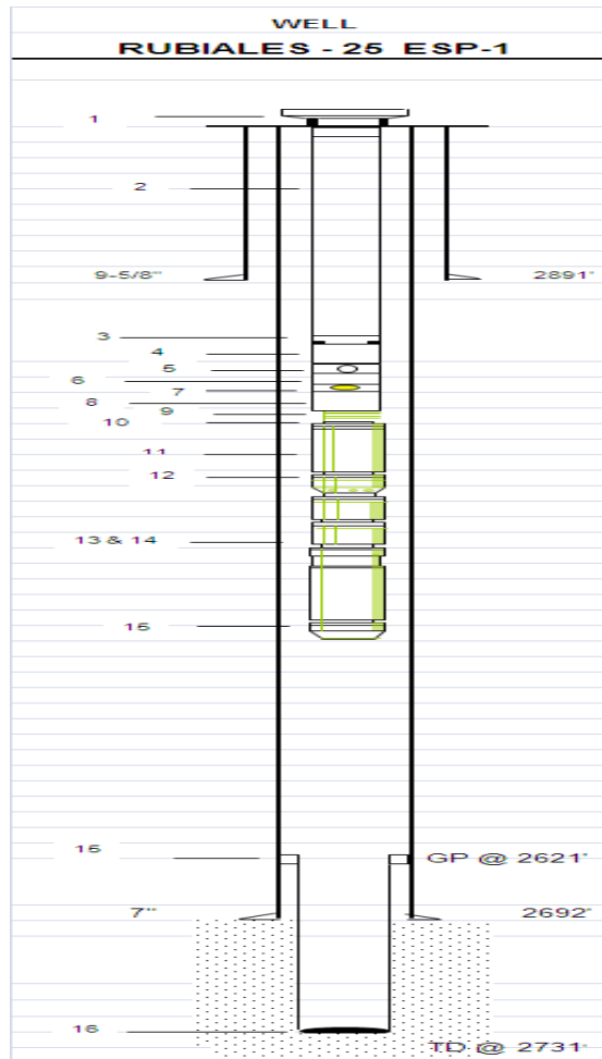
FIGURA 225. Completamiento Verticales ensanchado en hueco abierto
