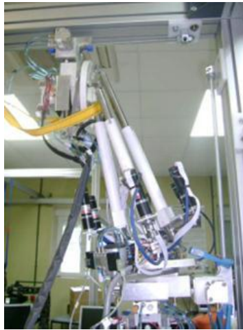
Figura 16. Fotografía del robot trepa en su fase de desarrollo
