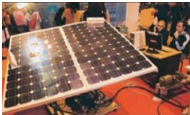
Figura 17. Fococelda posicionada por medio de una plataforma Stewart
