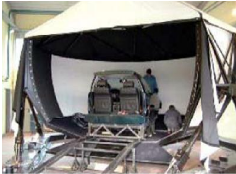
Figura 15. Plataforma Stewart utilizada en un simulador de manejo, por BMW
