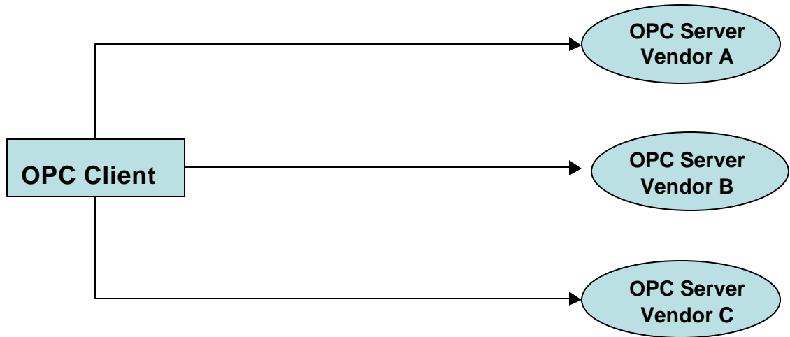
Figura 6. Conexión de un OPC cliente a diversos OPC servidores.
