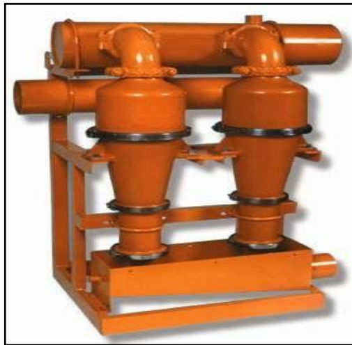
Figura 6. Equipo general de un Desarenador
