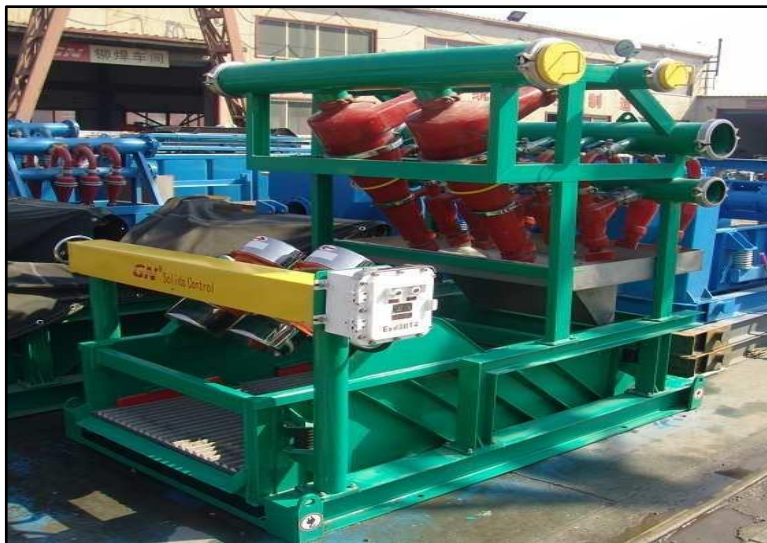
Figura 8. Equipo general de un mudcleaner
