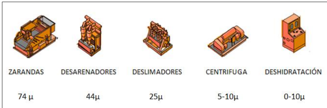
Figura 3. Puntos de corte en equipos de control de sólidos
