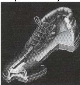
Figura 9. Estructura del calzado para trabajo
