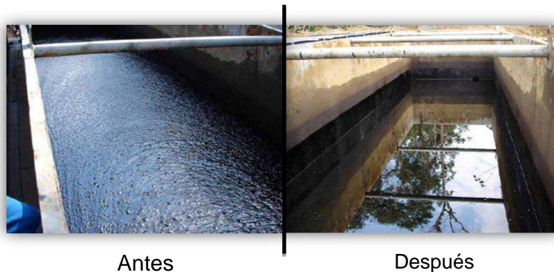
Figura 9. Efecto del Calentamiento y la Dilución en un crudo pesado.
