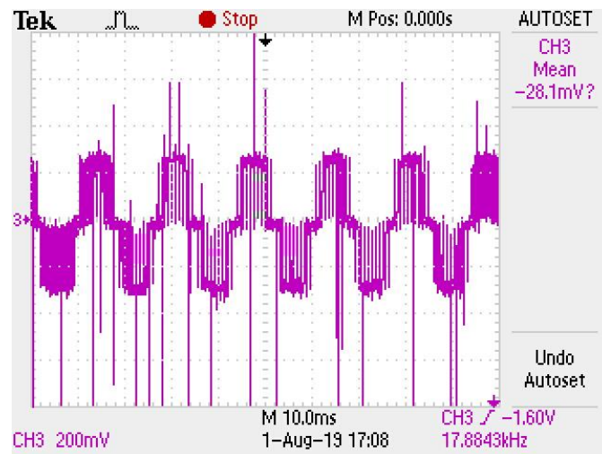
Figura 47. Forma de la señal corriente sin filtro.
