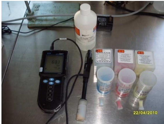
Figura 1. Medidor portátil de pH HACH SensION1.
