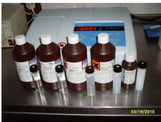
Figura 3. Turbidímetro HACH modelo 2100N
