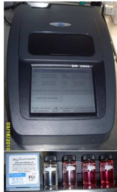
Figura 2. Espectrofotómetro HACH DR 2800
