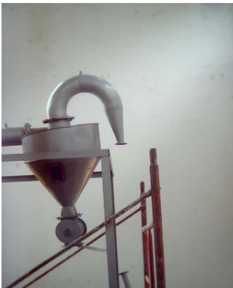
Imagen 13. Ciclón separador de cenizas
