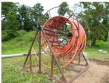
Imagen 7. Carrete fijado y ajustado en un burro
