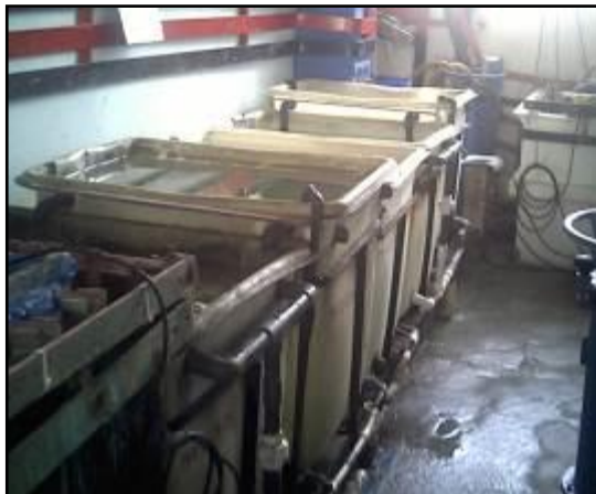
Figuras 6. Tanques plásticos utilizados en Fantaxias S.A.S. para el desengrase y enjuague de MAMUs.
