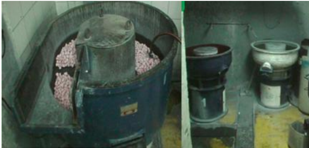
Figura 5. Maquinas vibradoras de la sección de pulido de la empresa Fantaxias S.A.S.
