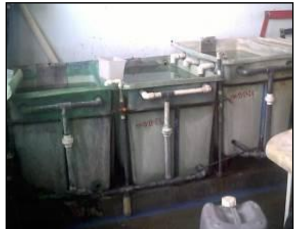
Figuras 6. Tanques plásticos utilizados en Fantaxias S.A.S. para el desengrase y enjuague de MAMUs.
