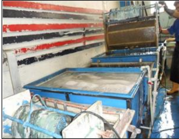
Figura 9. Baño electrolítico utilizado en Fantaxias S.A.S. para el cobrizado y niquelado de piezas MAMU
