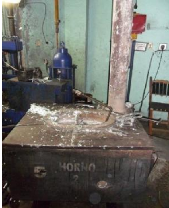
Figura 3. Horno para fundición de MAMU en Fantaxias S.A.S.
