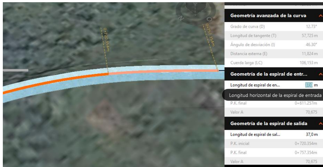
Figura 9. Longitud de espirales.
