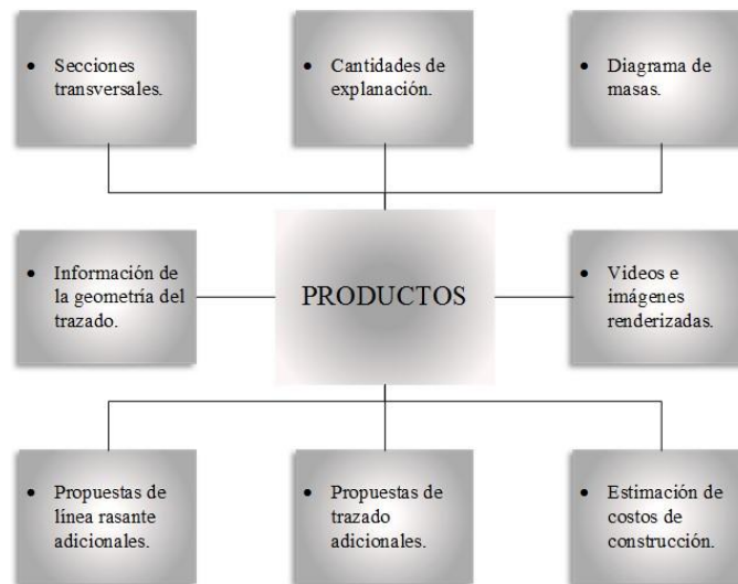
Figura 32. Productos del diseño geométrico de vías usando BIM.
