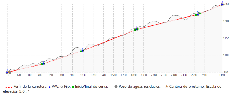
Figura 35. Vista de la vía en perfil. Fuente: Informe de optimización de perfil generado por Autodesk Infracore 360.
