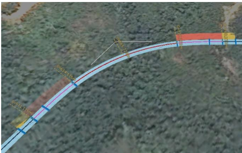
Figura 10. Zonas de transición del peralte.
