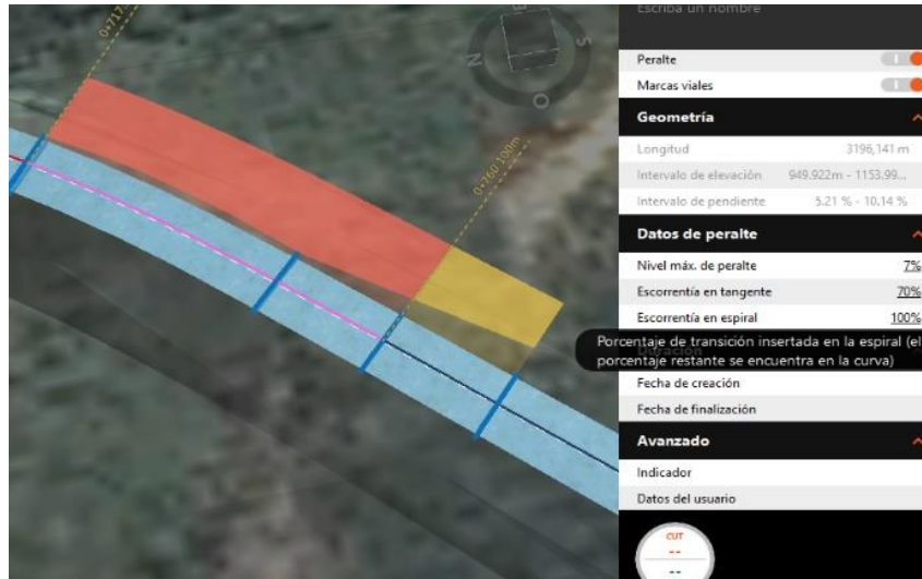
Figura 11. Longitud de espirales.
