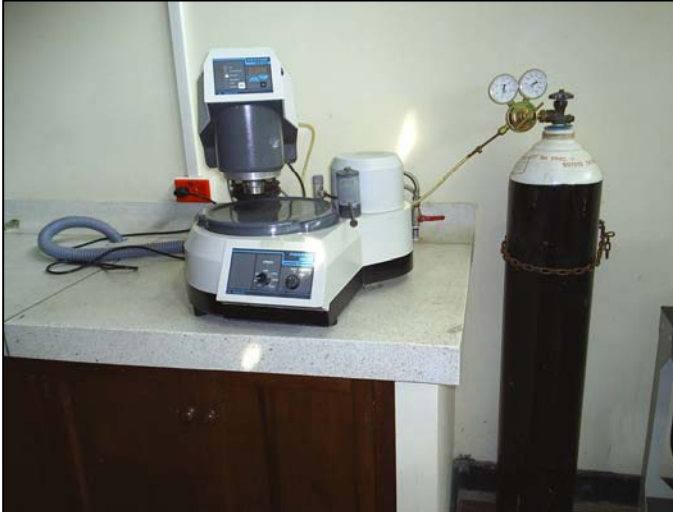
Figura 61. Pulidora automática Wurtz; usada para pulir las secciones, dejando su superficie brillante.
