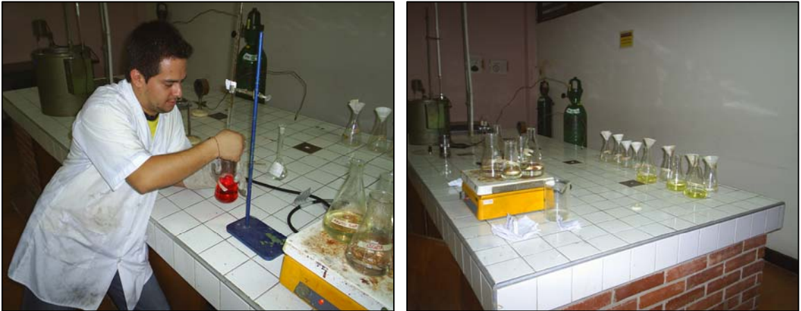
Figura 51. Determinación del contenido total de azufre mediante el Método de Eschka. Titulación y filtraje para eliminación de metales.
