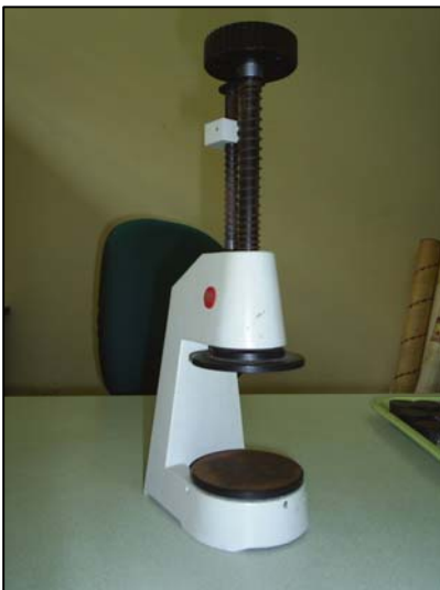
Figura 62. Equipos empleados en la descripción microscópica. a) Instrumento usado para ejercer presión sobre la sección para que pegue sobre un porta objetos con limpiatipos. b) Microscopio Fotómetro Zeiss Modelo MPM400 empleado en la descripción de macerales y toma de lecturas de Reflectancia de Vitritina.
