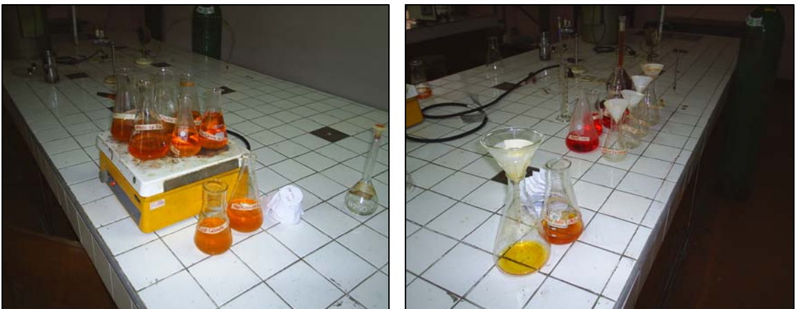
Figura 52. Calentamiento de muestras para eliminar y filtrar contenidos de \text{Na}_2\text{CO}_3 . El papel filtro se quema en el Horno o Estufa y se pesan las cenizas para saber el contenido total de azufre.
