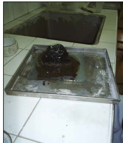
FIGURA 55. Proceso de pulimento. a) Usar la PULIDORA DESVASTADORA BUEHLER con abrasivo No. 250 sobre la superficie del corte para alisarla. b) Después, se prosigue con vidrio para dejar cada vez más limpia la superficie, aplicando abrasivo No. 400, 600 y 1000 respectivamente.
