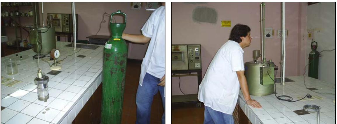
Figura 50. Ensamble de la Bomba Calorimétrica. a) Se llena con oxígeno la bomba para producir la ignición interna con la muestra de carbón. b) Vigilar constantemente durante la quema para anotar la variación que hay de temperatura interna en la bomba.
