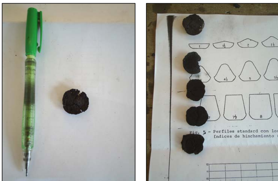
Figura 47. Botón de coque resultado al final de la prueba. Se emplea una tabla de comparación que contiene valores entre 1 – 9 para indicar que carbón es aglomerante o coquizable.
