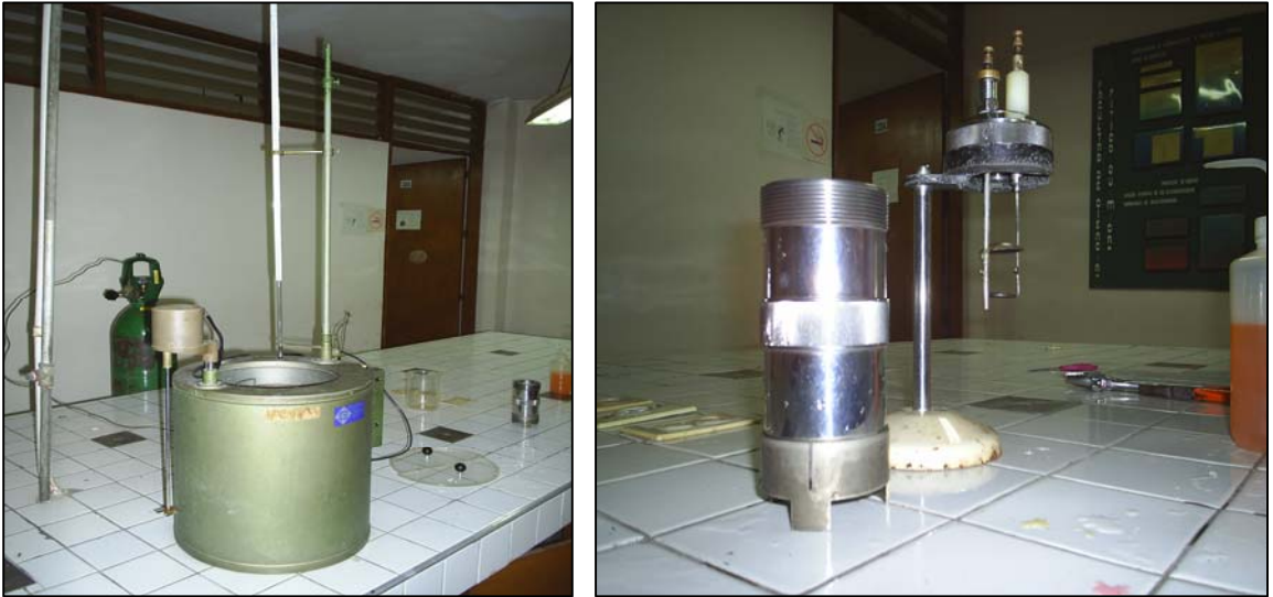
Figura 50. Ensamble de la Bomba Calorimétrica. a) Se llena con oxígeno la bomba para producir la ignición interna con la muestra de carbón. b) Vigilar constantemente durante la quema para anotar la variación que hay de temperatura interna en la bomba.
