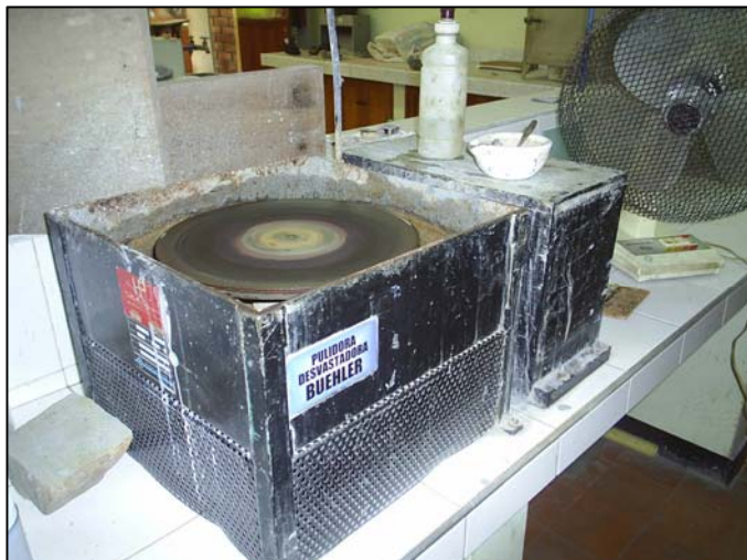
FIGURA 55. Proceso de pulimento. a) Usar la PULIDORA DESVASTADORA BUEHLER con abrasivo No. 250 sobre la superficie del corte para alisarla. b) Después, se prosigue con vidrio para dejar cada vez más limpia la superficie, aplicando abrasivo No. 400, 600 y 1000 respectivamente.
