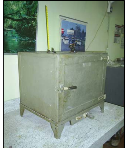
Figura 54. Equipo usado en los cortes de litotipos en carbones. a) Cortar con la CORTADORA MINOSECAR 2 ROW-RATHENO, y dejar durante tres días en el b) Horno, con el fin de eliminar la mayor cantidad de humedad.
