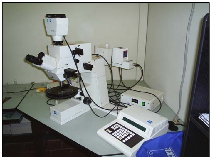
Figura 62. Equipos empleados en la descripción microscópica. a) Instrumento usado para ejercer presión sobre la sección para que pegue sobre un porta objetos con limpiatipos. b) Microscopio Fotómetro Zeiss Modelo MPM400 empleado en la descripción de macerales y toma de lecturas de Reflectancia de Vitritina.
