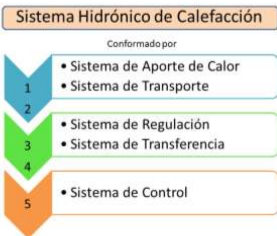
Figura 32. Sistemas que componen el banco
