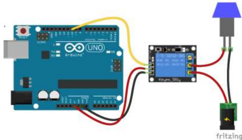
Figura 58. Conexión del control realizado por la tarjeta arduino en los relés de estado solido
