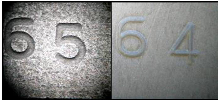
Figura 14. Cupones L-80 después de una prueba de corrosión a 260°F
