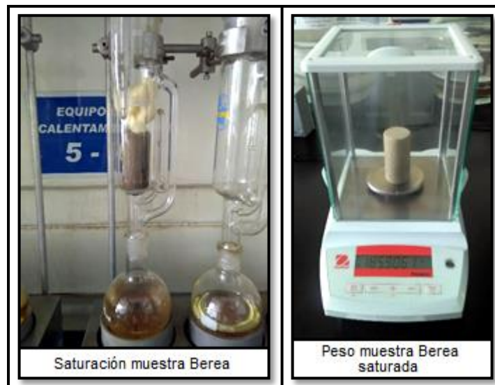
Figura 49. Proceso de limpieza y saturación muestra Berea
