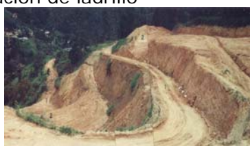
Figura 4.4. Zonas de extracción a cielo abierto de Materia Prima para fabricación de ladrillo
