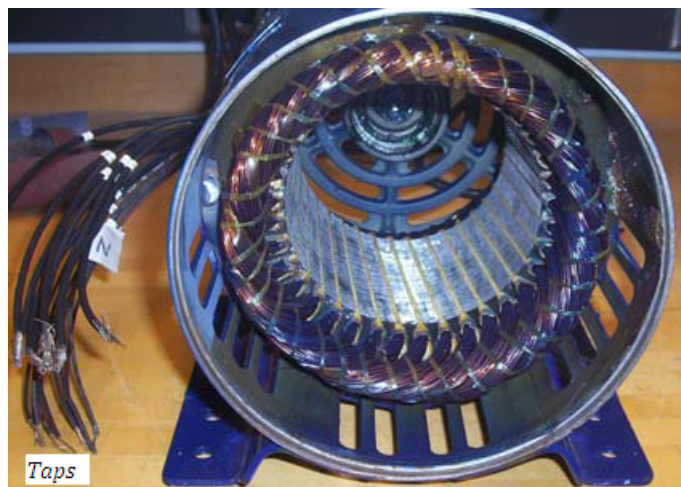
Figura 5.3: Bobinado del estator construido para la emulación de fallas internas de corto circuito en un motor de inducción
