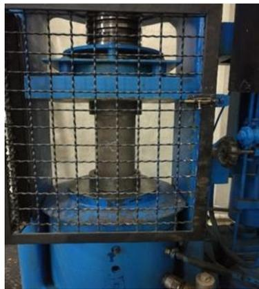
Para los ensayos a tracción indirecta, más conocido como ensayo brasileño, se llevaron a cabo según la norma ASTM C-496, donde la velocidad implementada en los ensayos fue de 3 [mm/min] hasta obtener un desplazamiento último de aproximadamente 8 [mm] (Figura 10). Este ensayo se realizó para 11 cilindros por cada uno de los puntos experimentales, para un total de 286 especímenes ensayados.
