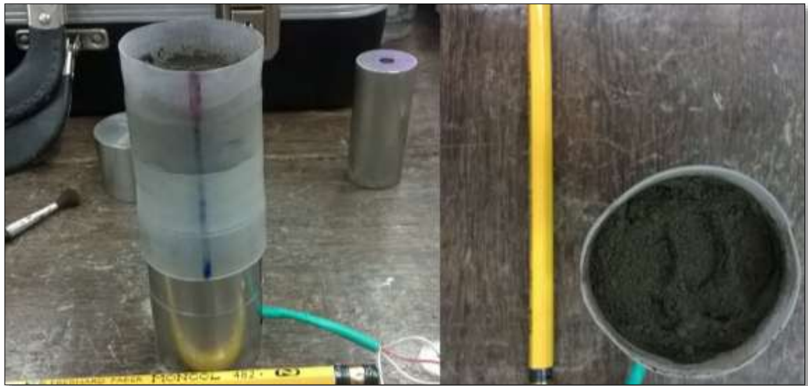
Figura 31. Montaje de la muestra dentro de una chaqueta de material termoencogible, utilizada para evitar la pérdida de muestra durante la compactación.
