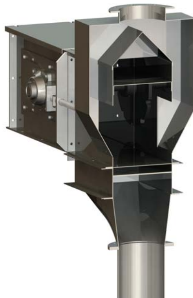
Figura 82. Corte tolva de alimentación lateral y rasera de descarga transportador de cadena.
