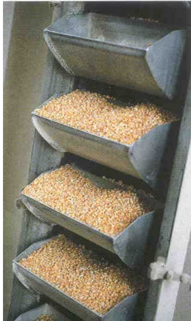
Figura 40. Cangilones y banda de elevador
