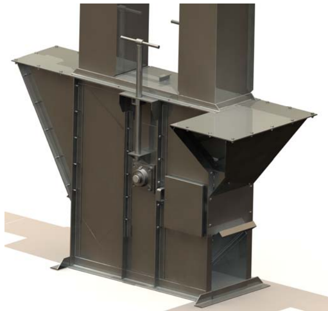
Figura 101. Tolva de carga modificada para elevador
