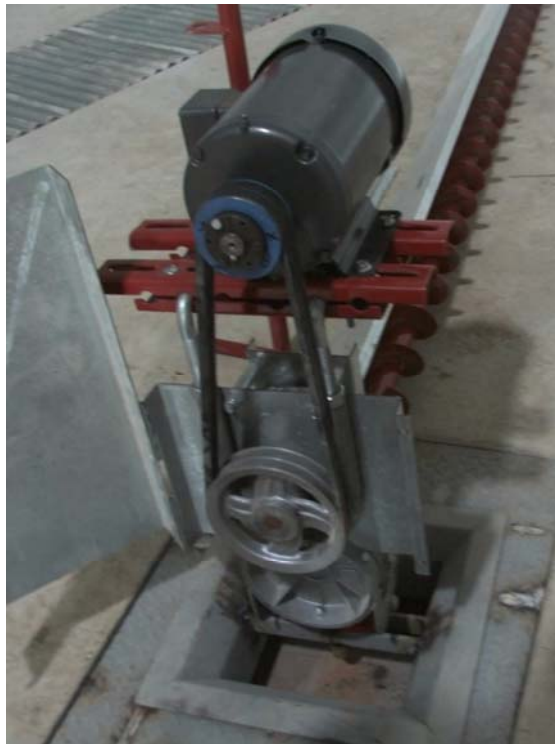
Figura 149. Montaje motor y transmisión sinfín barreador
