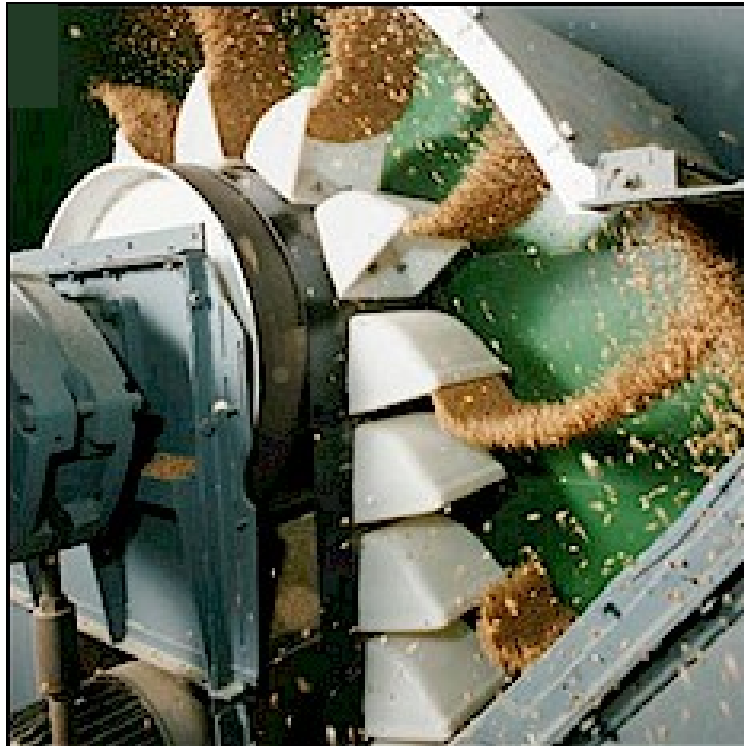
Figura 41. Descarga elevador de cangilones
