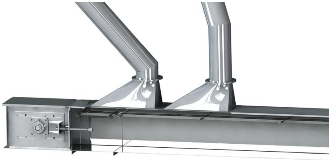
Figura 79. Transición de entrada para transportador TC-01
