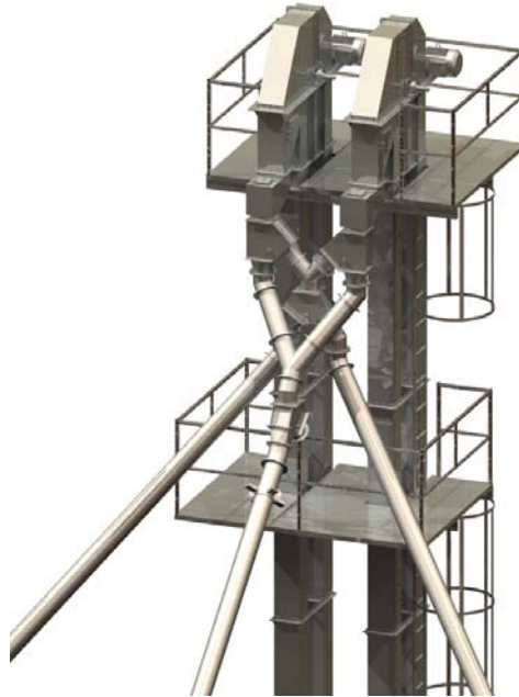
Figura 104. Montaje cajas de cambio salida elevadores
