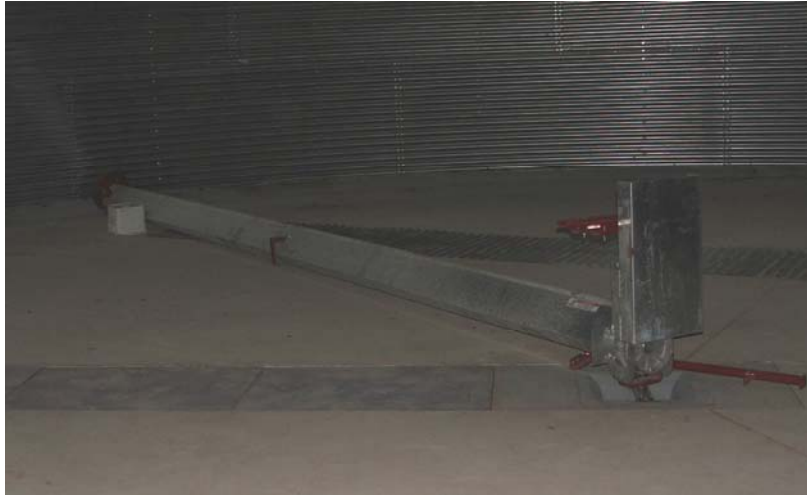
Figura 147. Ensamble sinfín barredor
