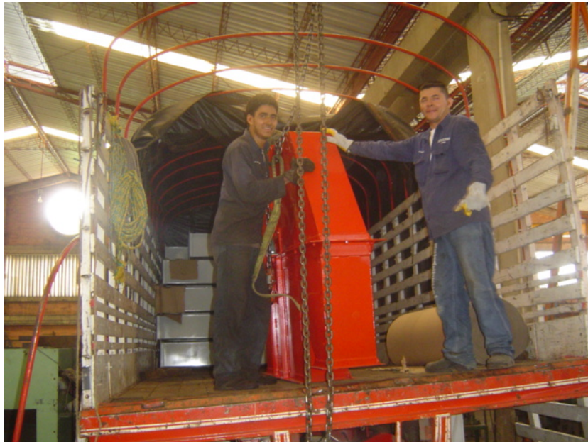
Figura 119. Cargue cabezote elevador de cangilones
