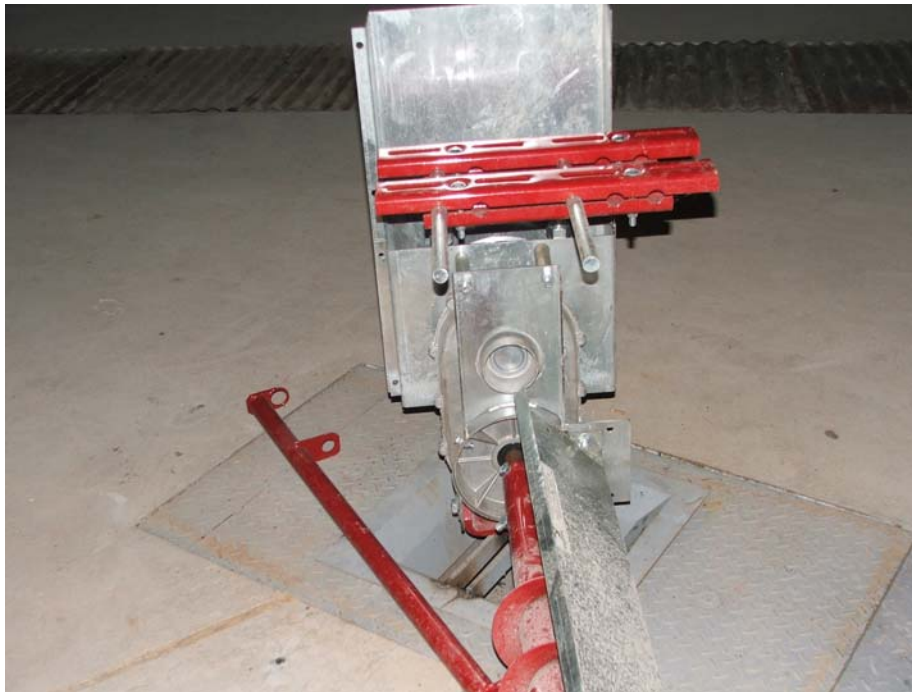
Figura 148. Ensamble sinfín barredor boca de entrada
