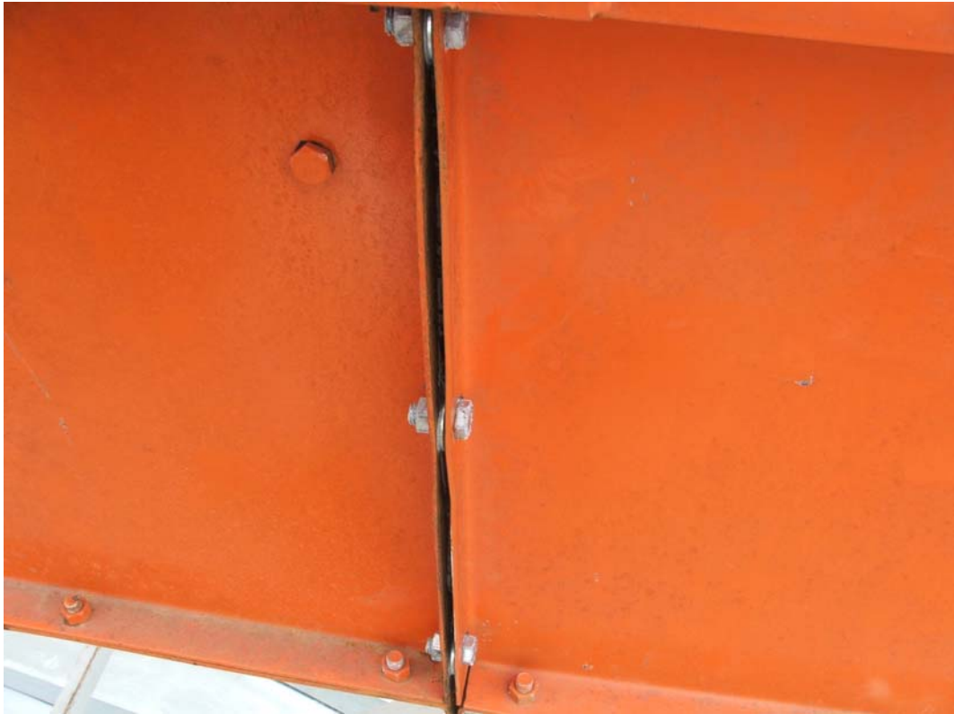
Figura 143. Arandelas de alineación (calzas) para transportador
