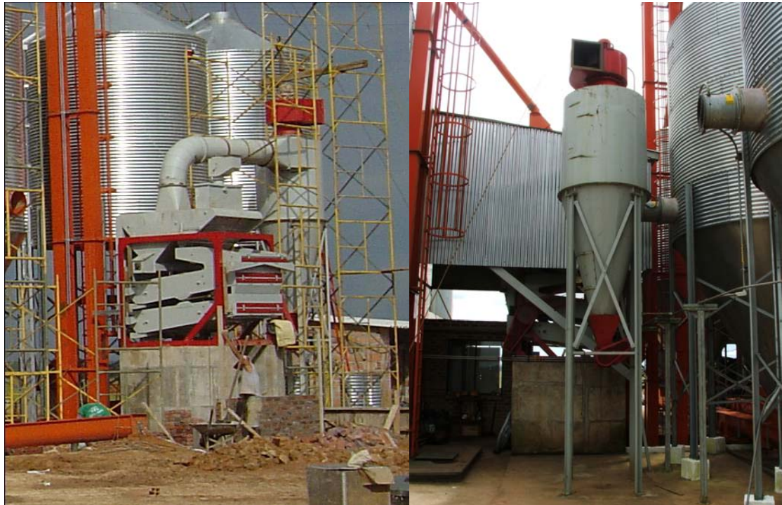
Figura 5. Limpiadora de cereales doble, ciclón, ventilador y esclusa.
