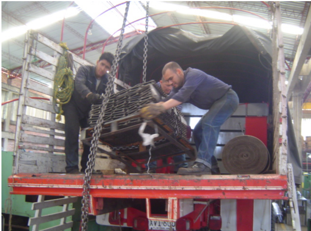
Figura 120. Cargue cadena de arrastre transportador de cadena
