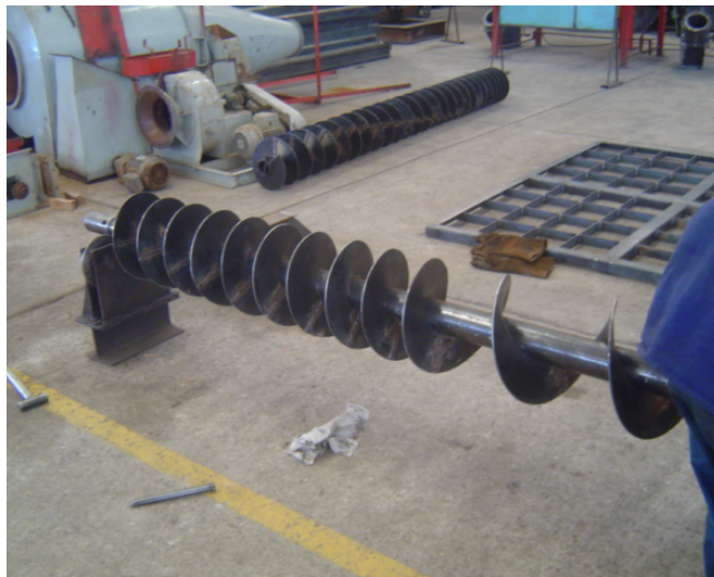
Figura 117. Extensión rosca sinfín de descarga silos
