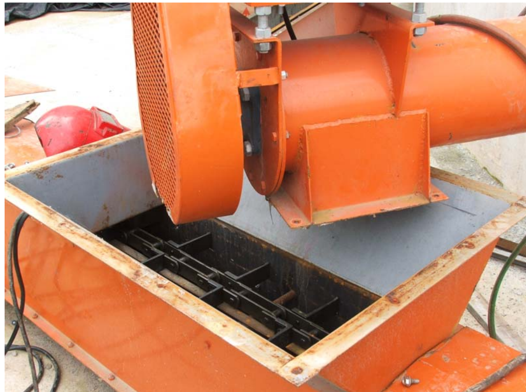
Figura 152. Instalación tolvas de carga TC-04
