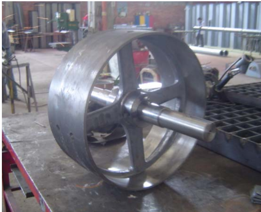
Figura 111. Elaboración polea de tracción elevador de cangilones
