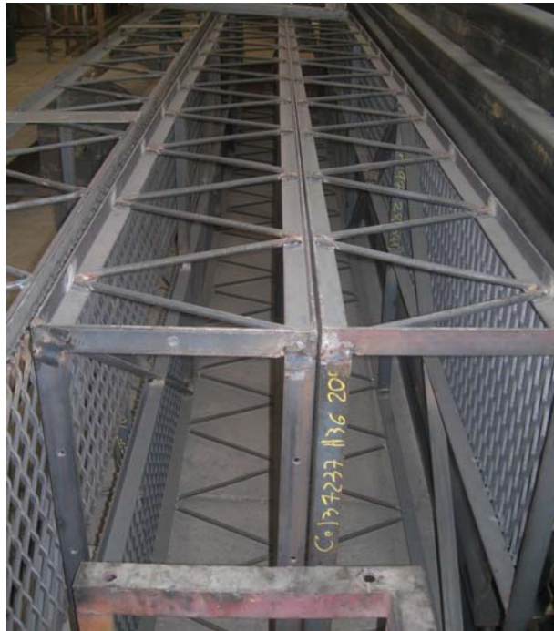
Figura 108. Fabricación pasarelas de mantenimiento
