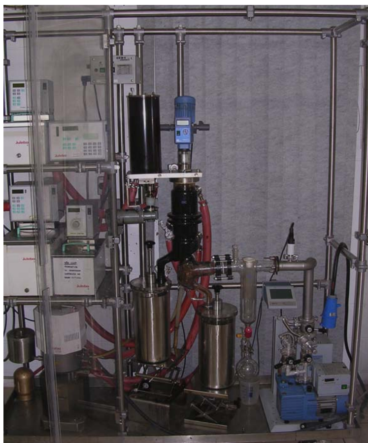
Figura B1. Foto en detalle del Destilador Molecular de Película descendente perteneciente al LDPS/FEQ/UNICAMP.
