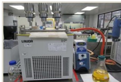
Figura A10. Sistema de filtración.
