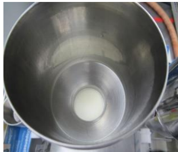
Figura A12. Precapa para filtración.
