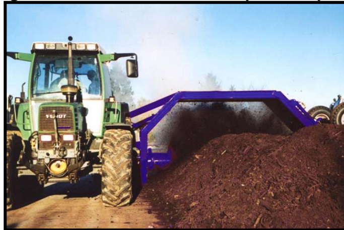
Fotografía 7. Volteadora/aireadora para compostaje.
