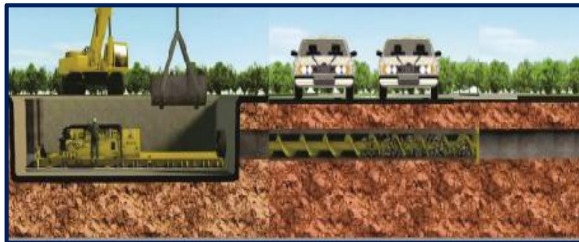
Figura 15. Inicio de la Perforación
