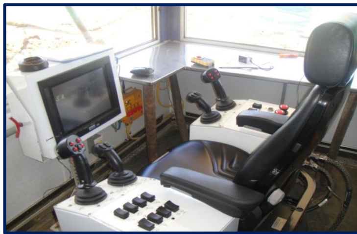
Figura 29. Cabina de Comando de la Máquina de Perforación
