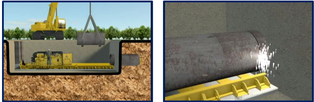
Figura 16. Soldadura de Tubería por Termofusión
