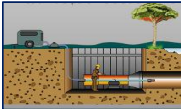
Figura 6. Instalación del Equipo RAM
