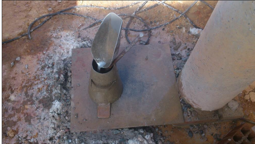
Figura 29. Herramientas prueba de asentamiento
