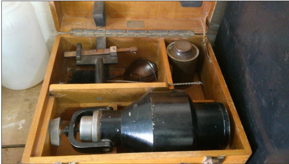
Figura 12. Equipo para calcular la humedad (Humedómetro)
