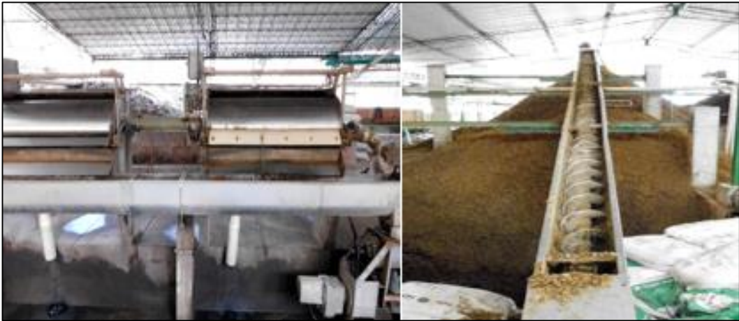
Figura 12. Filtro de tambor rotacional y tornillo de transporte de lodos amarillos.
