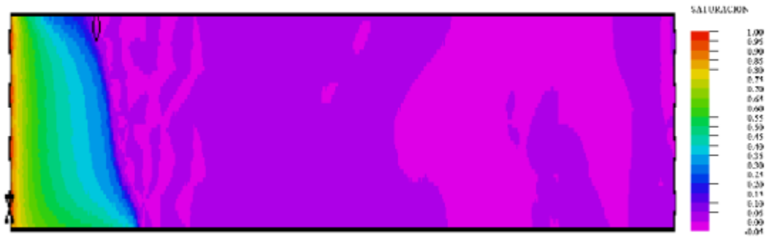
Figura 4.34: Perfil de saturaciones de agua FLEXPDE a 180 días.
