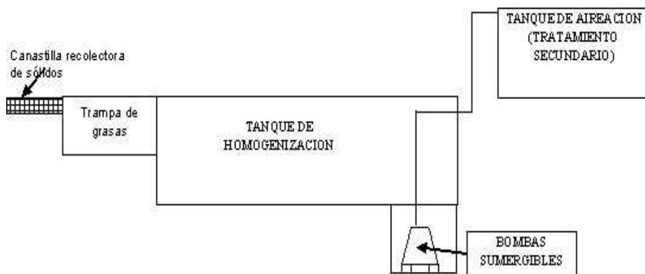
Figura 17. Entrega trampa de grasas a tanque de homogenización
